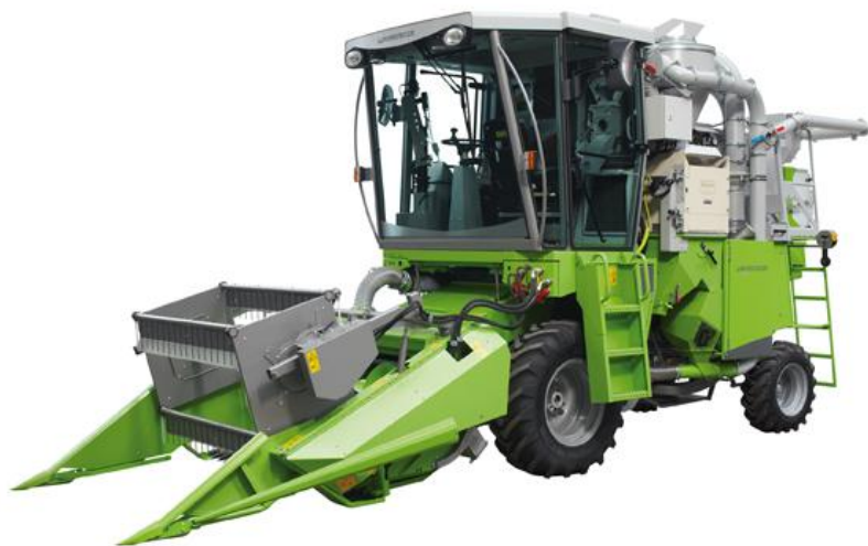
Obr. 33 Univerzální sklízecí mlátička Delta [8]
