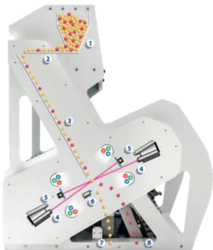
Obr. 36 Princip třídění barevné třídíčky [25]
