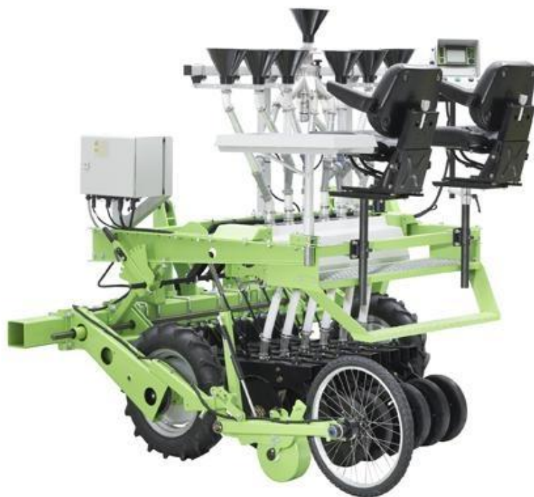
Obr. 26 Parcelní secí stroj pro výsev jednotlivých řádků Rowseed XL [8]
