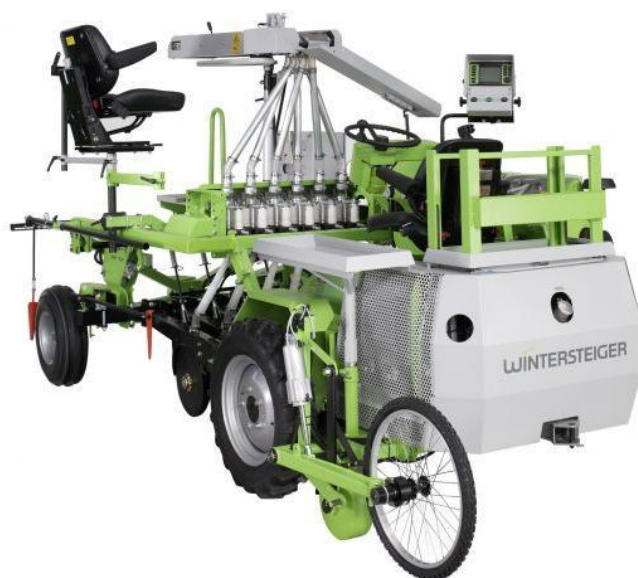
Obr. 24 Samochodný secí stroj pro výsev jednotlivých řádků Rowseed TC [8]
