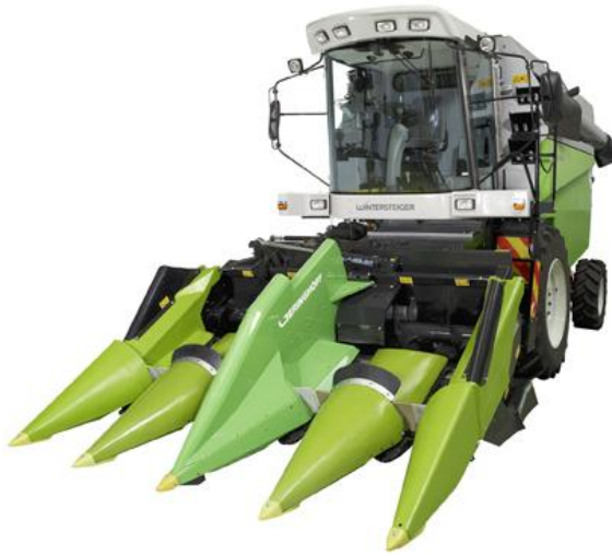
Obr. 34 Sklízecí mlátička dvou parcel Split [8]
