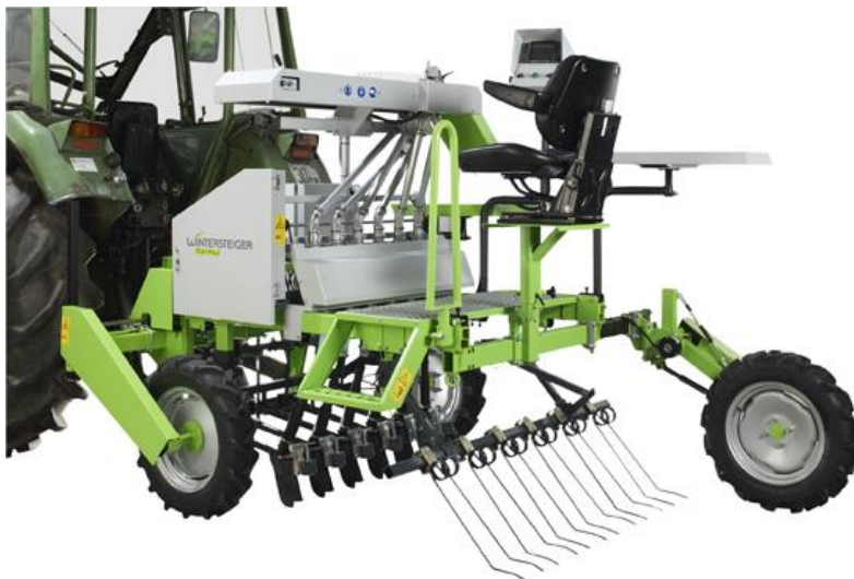
Obr. 25 Parcelní secí stroj pro výsev jednotlivých řádků Rowseed S [8]
