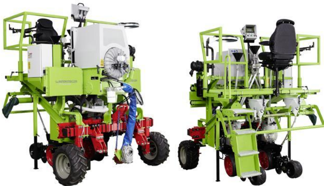
Obr. 29 Pneumatický přesnosecí stroj jednotlivých semen Dynamic Disc [8]
