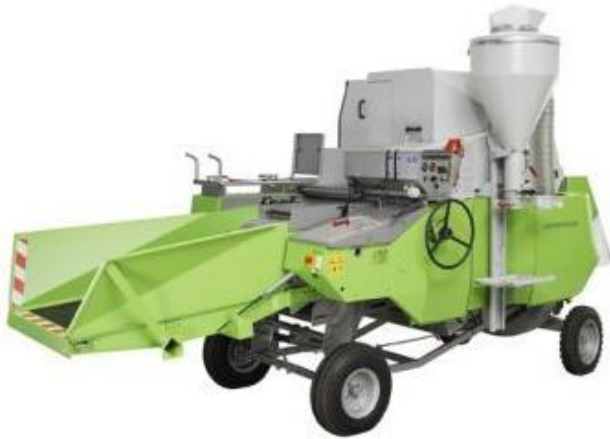
Obr. 35 Stacionární sklízecí mlátička Classic ST [8]
