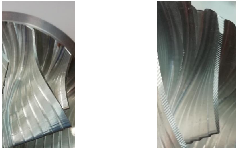
Obr. 31: Snímek lopatek po druhém hrubování pro sjednocení přídavku lopatek.
