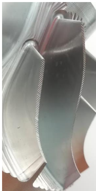
Obr. 34: Znárodnění povrchu po dokončení lopatek a mezi-lopatek.
