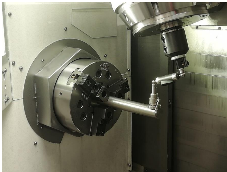
Obr. 44: Double ball bar aparatura od firmy Renishaw.
