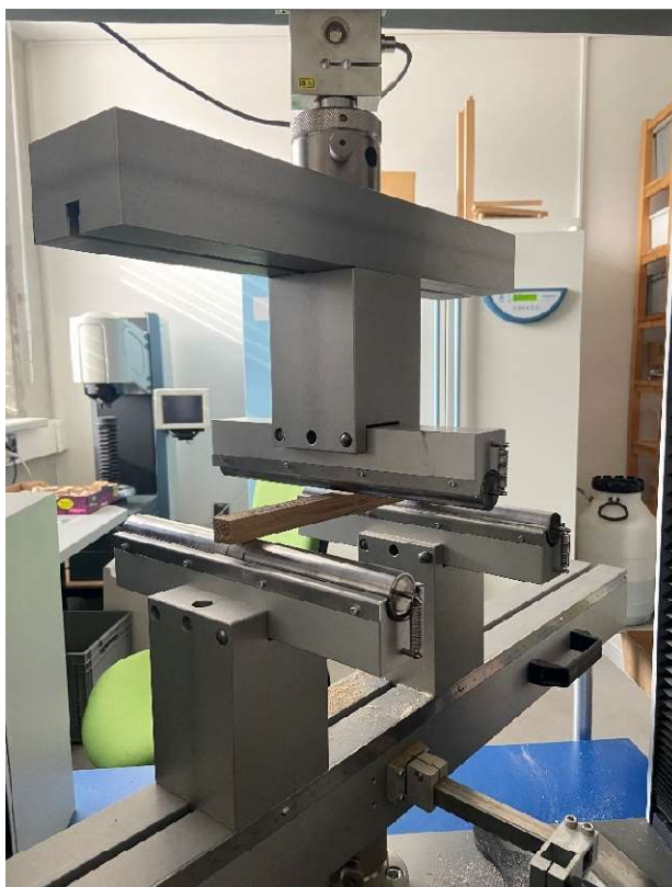
Obrázek 24 Zkouška pevnosti v ohybu na stroji TIR (vlastní tvorba)
