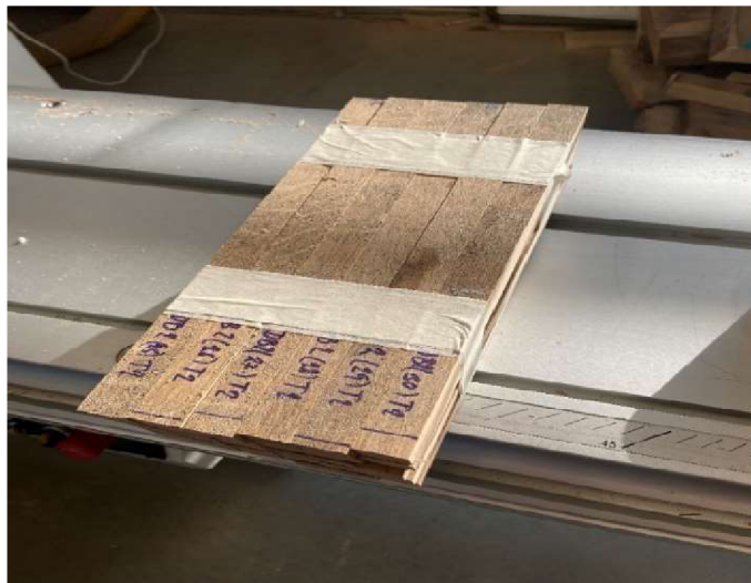
Obrázek 19 Normované vzorky 20x20x300 mm (vlastní tvorba)
