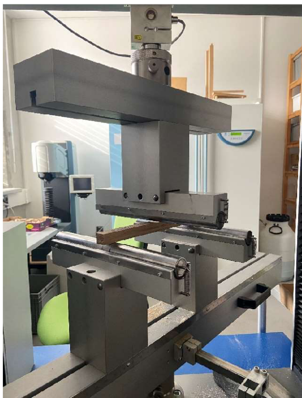
Obrázek 24 Zkouška pevnosti v ohybu na stroji TIR (vlastní tvorba)
