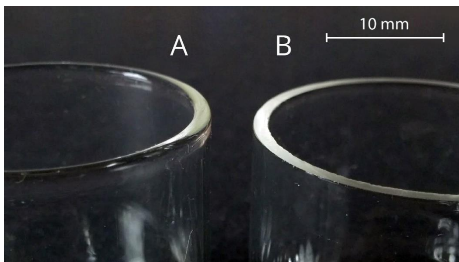
Obrázek 34 - Detail hran optimalizovaných spinnerů, A – zakulacená hrana, B – zabroušená hrana
