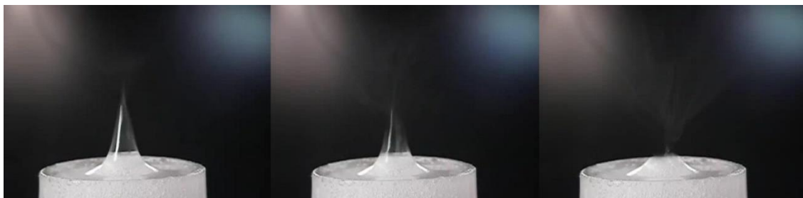
Obrázek 7 - Proces prasknutí bubliny v elektrickém poli – převzato z [14]
