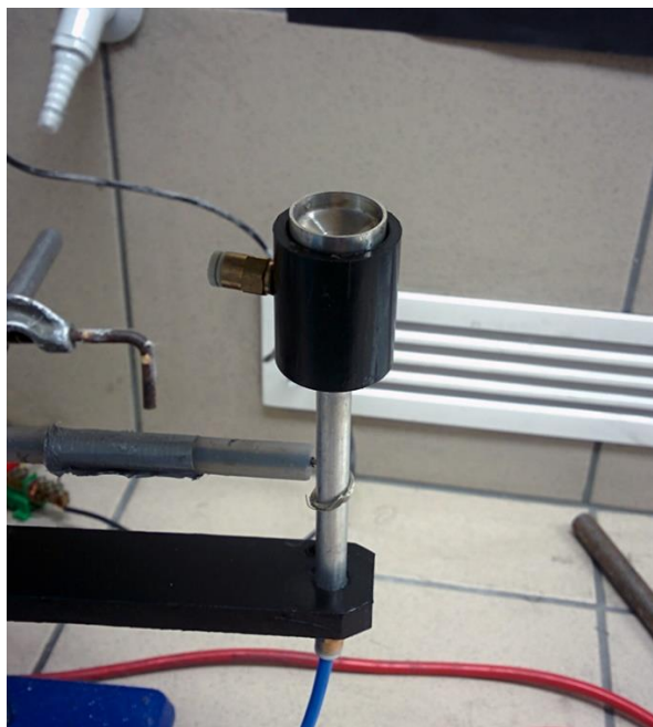
Obrázek 26 - Původní spinner pro metodu bubble spinning
