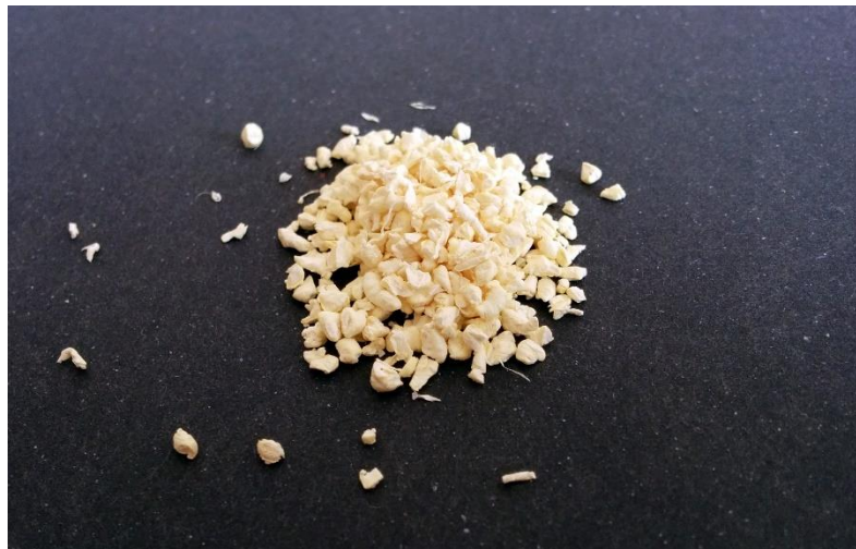
Obrázek 12 - Granulát polyimidu použitý pro účely této práce
