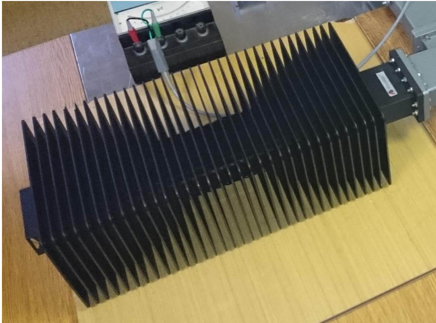
Obrázek 2.3 Bezodrazová zátěž absorbující výkon
