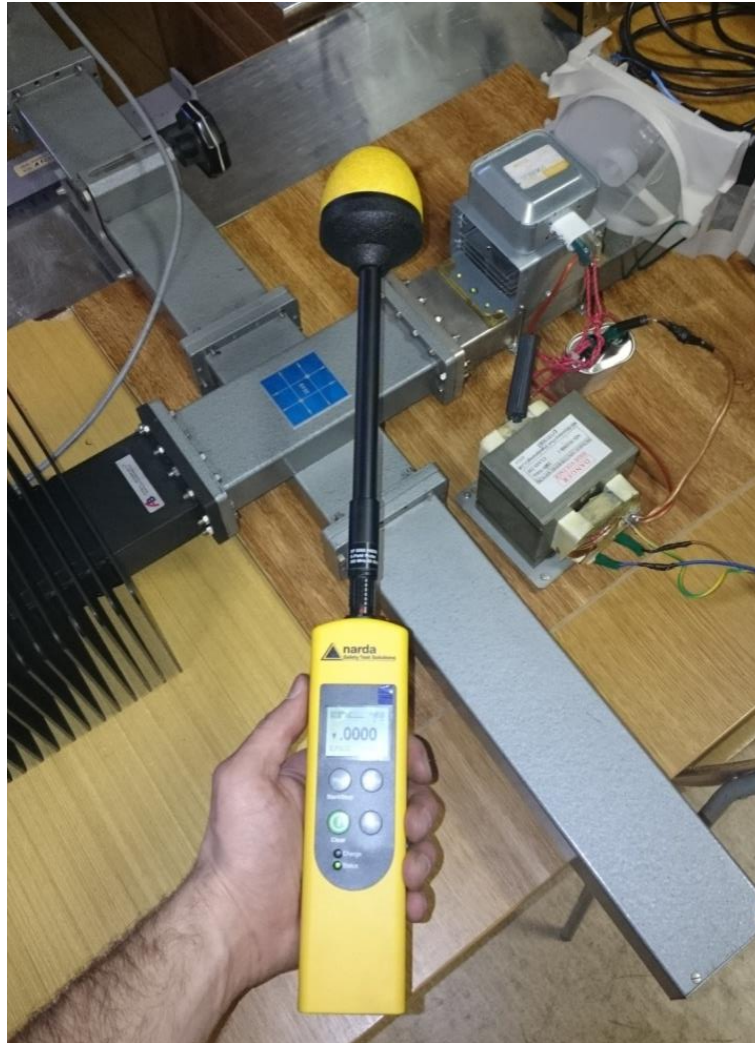
Obrázek 4.2 Měření přítomnosti výkonového vyzařování
