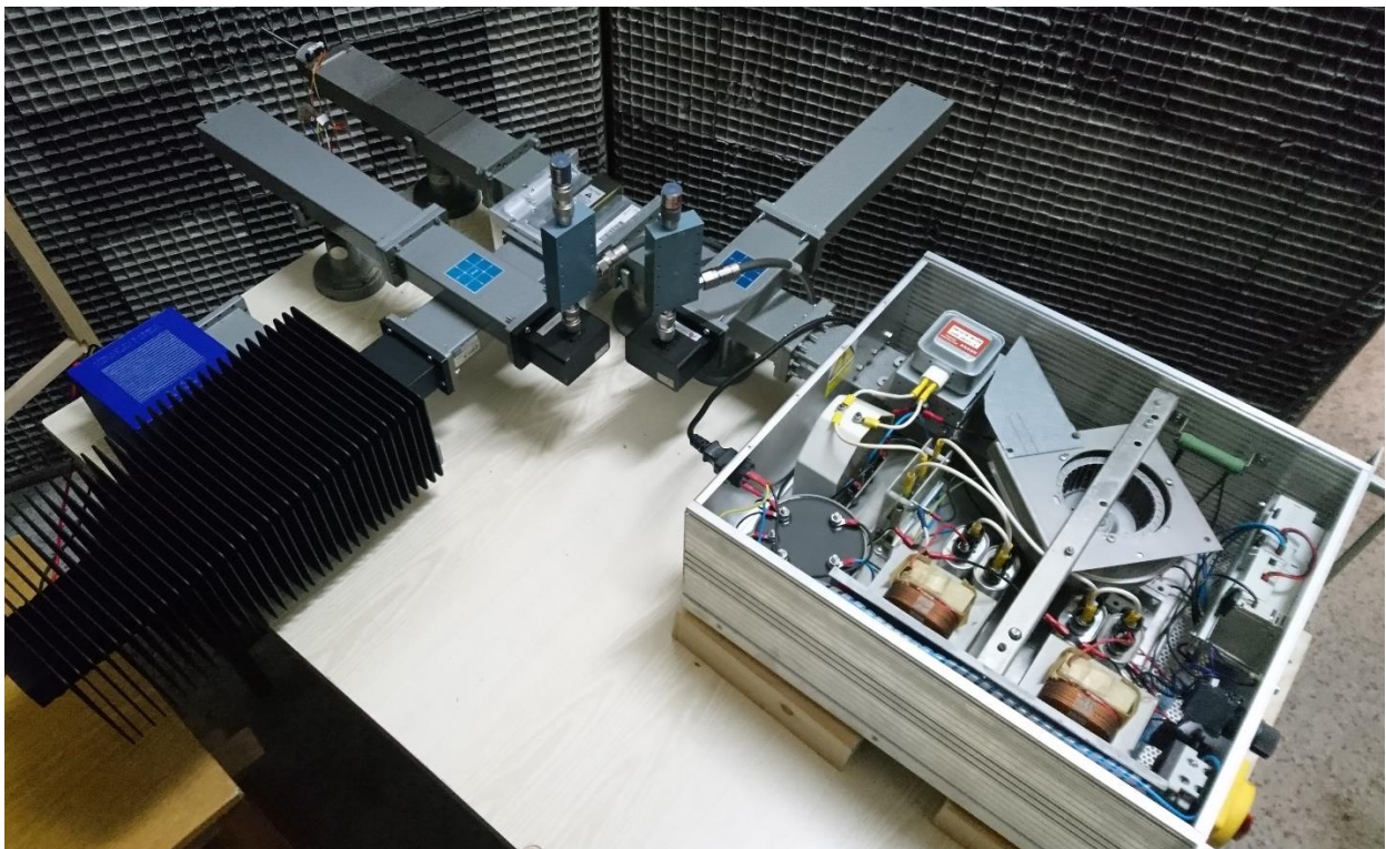
Obrázek 4.5 Zapojení laboratorního systému pro měření výkonu
