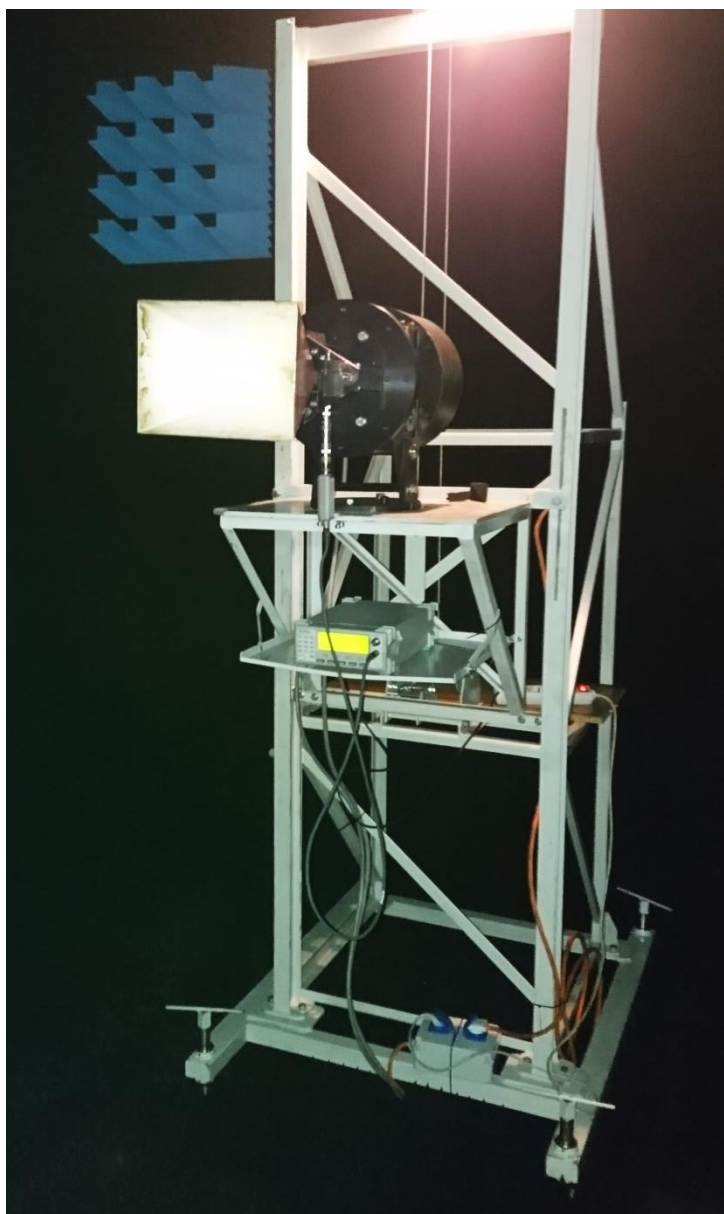
Obrázek 7.5 Měření směrových charakteristik v bezodrazové komoře – měřicí část s referenční anténou
