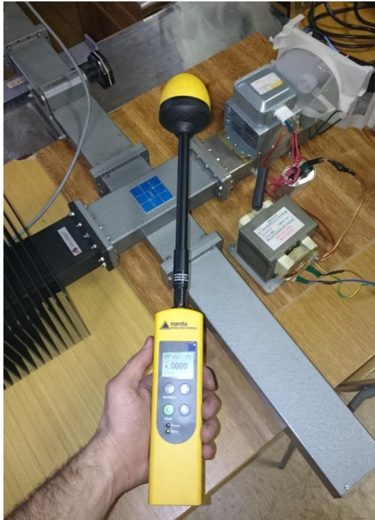
Obrázek 4.2 Měření přítomnosti výkonového vyzařování
