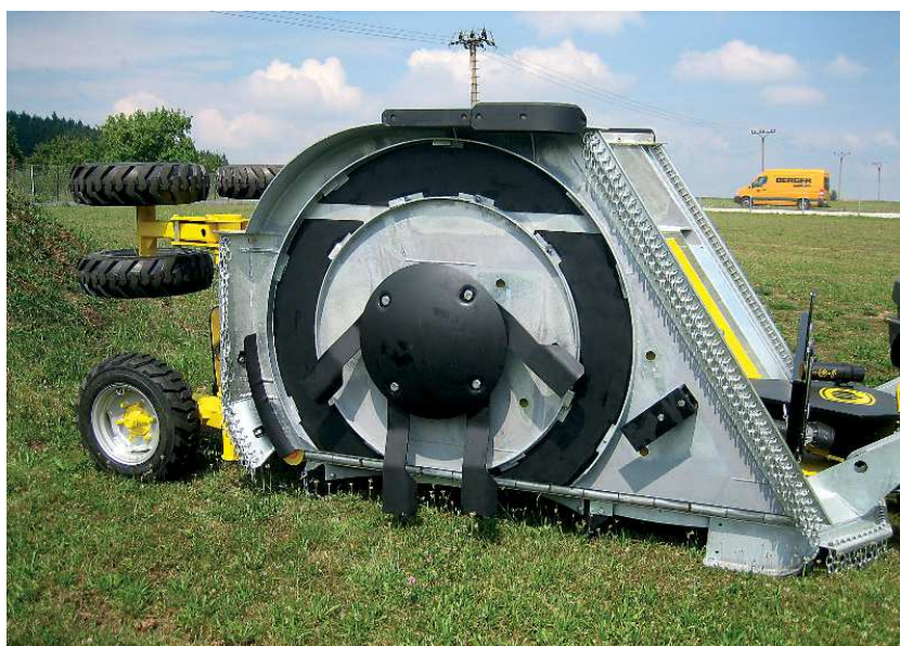
Obrázek 8 Mulčovač MZ 4500 s vertikální osou rotace s pracovním záběrem 4,5 m od firmy BEDNAR FMT [5]
