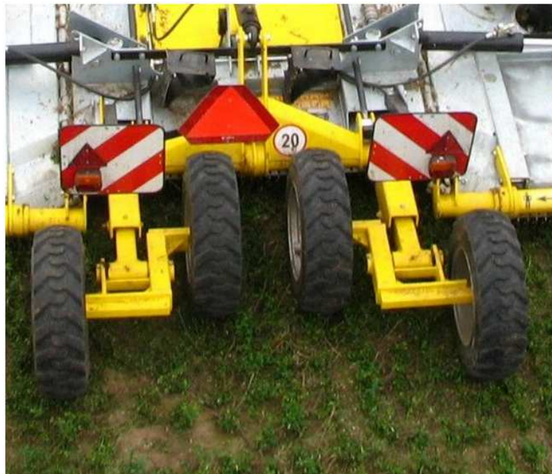
Obrázek 9 Kráčející náprava ve střední části mulčovače s vertikální osou rotace [5]
