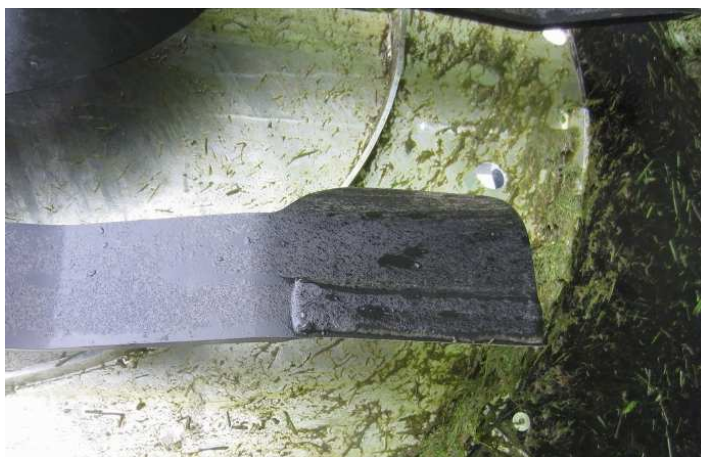
Obrázek 28 Karbidový návar na spodní straně břitu pracovního nástroje mulčovače [6]
