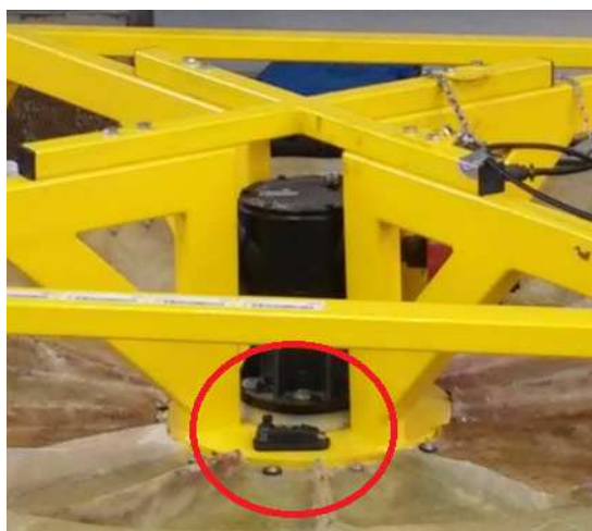
Obrázek 39 Umístění akcelerometru na modelu mulčovače
