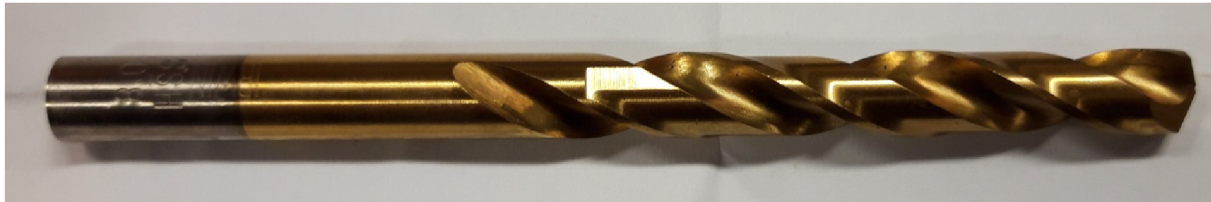
Obr. 04 Ukázka šroubovitého vrtáku ČSN 22 1121 (DIN 338)
