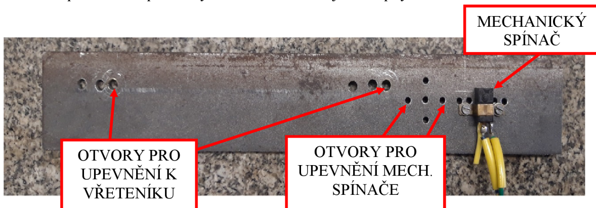
Obr. 12 Konstrukční prvek – příložka
