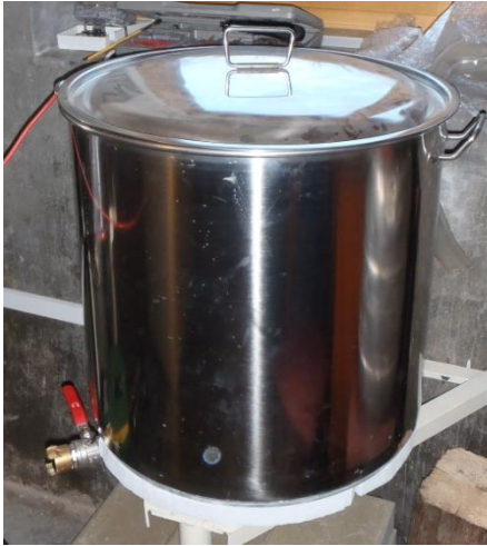
Obrázek 9 Nanopivovar s tištěnými topnými spirálami
