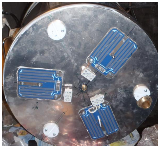
Obrázek 8 Umístění tištěných topných spirál
