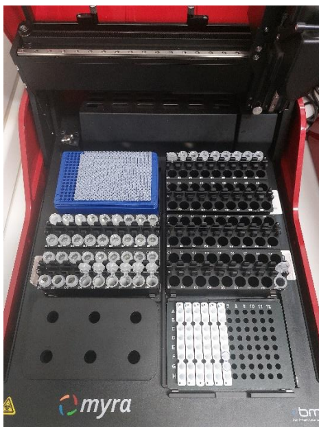
Obrázek číslo 5: Pipetovací stanice Myra s vloženými vzorky a stripy, Biovendor LM ČR
