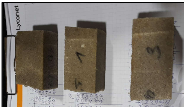
Obrázek 25 Referenční polymerbetony s křemičitými písky ETAPA XII (autor)
