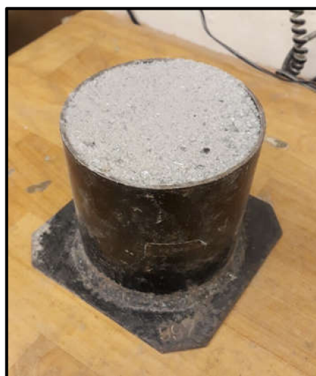
Obrázek 23 Pyknometrické stanovení objemové hmotnosti (vlevo), stanovení sypné hmotnosti a mezerovitosti (vpravo) (autor)
