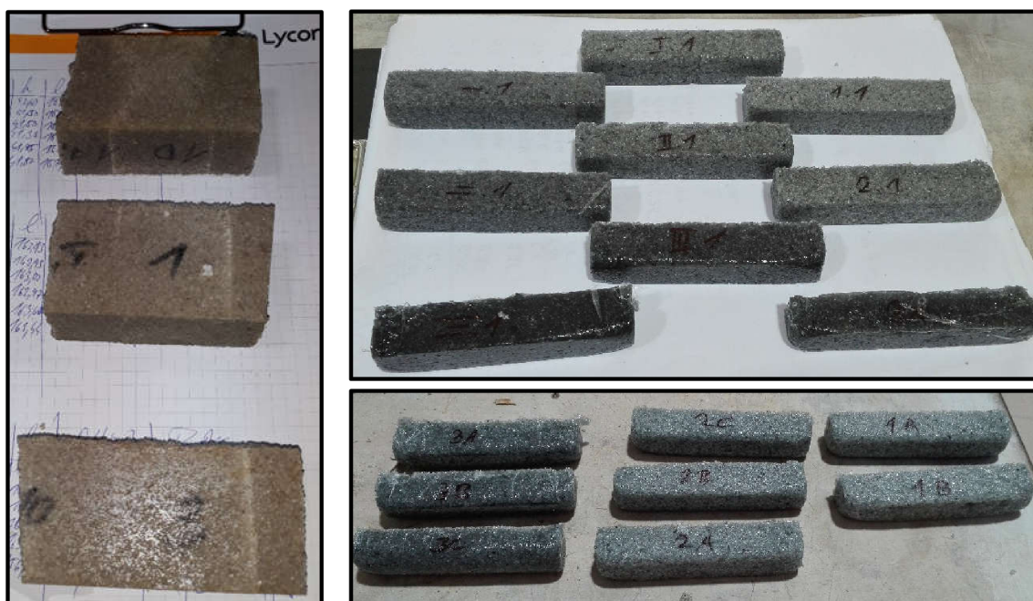
Obrázek 24 Porovnání barvy polymerbetonů z křemičitých písků (vlevo) a mletého skla (vpravo) (autor)
