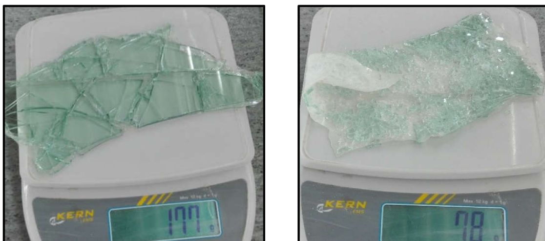
Obrázek 16 Štěp skla před drcením (vlevo) a po drcení v čelistovém drtiči (vpravo) (autor)
