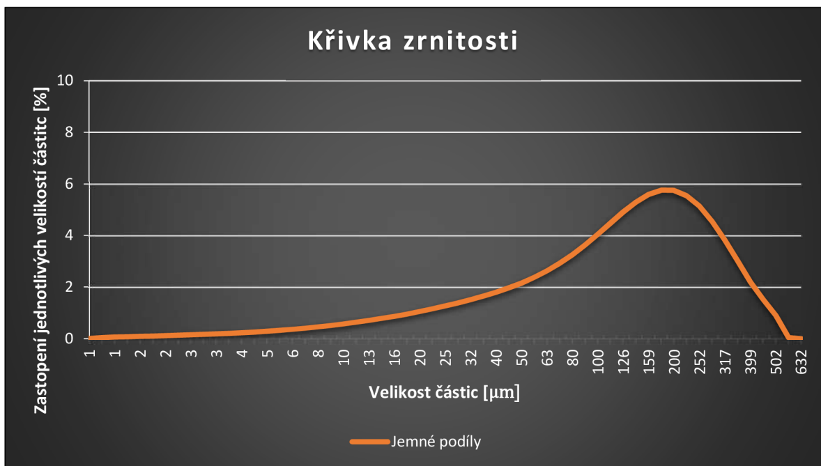
Graf 14 Křivka zrnitosti - laserová granulometrie jemných podílů
