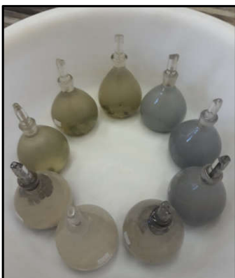
Obrázek 23 Pyknometrické stanovení objemové hmotnosti (vlevo), stanovení sypné hmotnosti a mezerovitosti (vpravo) (autor)
