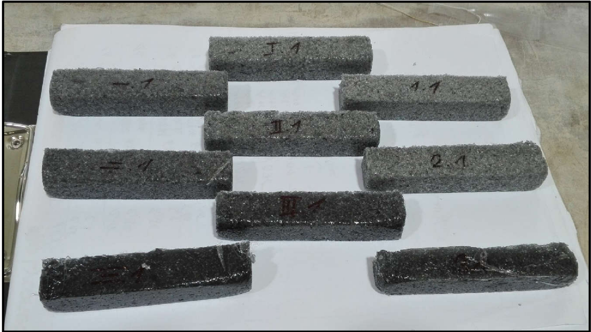
Obrázek 20 Polymerbetonové zkušební vzorky z mletého skla, nahoře 1:15, uprostřed 1:10 a dole 1:5 ETAPA IX (autor)
