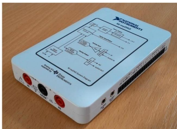
Obr. 1. Fotografie měřicího rozhraní National Instruments myDAQ
