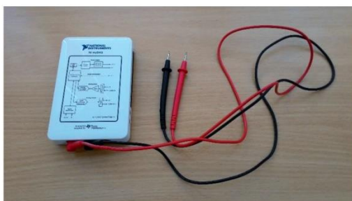
Obr. 6. Rozhraní NI myDAQ se zapojeným multimetrem
