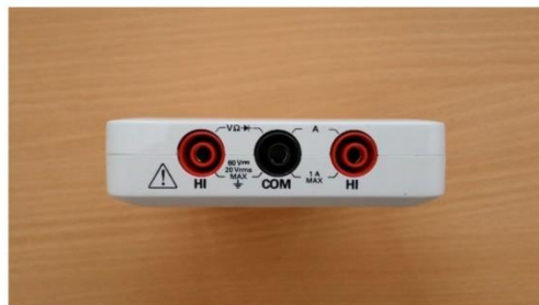
Obr. 7. Zdíčky pro připojení měřicích sond multimetru
