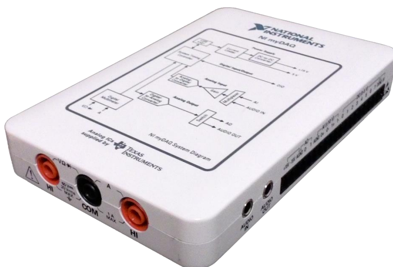
Obr. 1. Vzhled měřicího rozhraní National Instruments myDAQ 9
