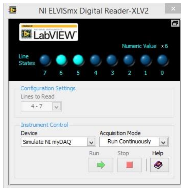
Obr. 25. Osmikanálová logická sonda (NI ELVISmx Digital Reader)
