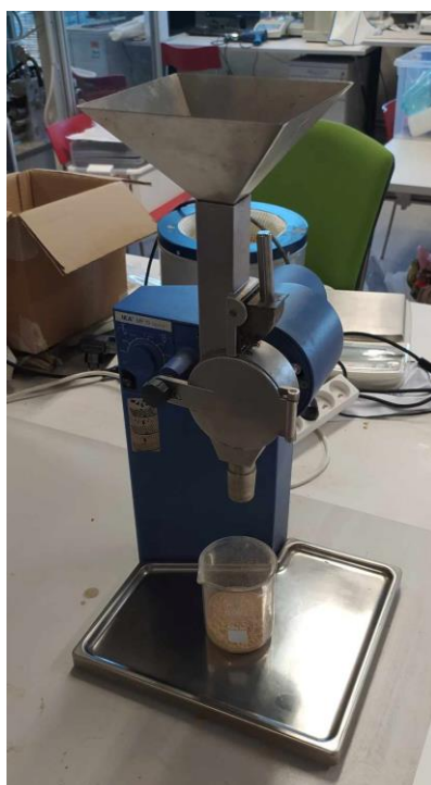
Obrázek 16 Mlýnek mikrojemný, MF 10 basic (Zdroj: autorka práce, 2023)
