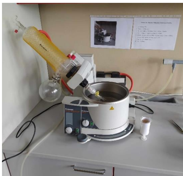
Obrázek 22 Vakuová rotační odparka (Zdroj: autorka práce, 2023)
