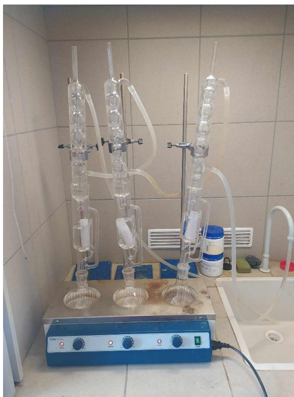
Obrázek 19 Soxhletova aparatura (Zdroj: autorka práce, 2023)
