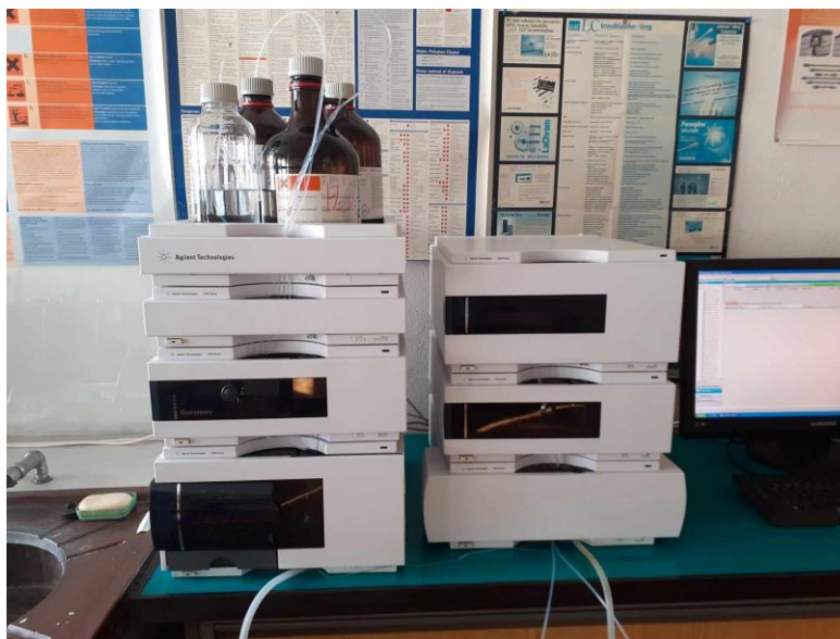
Obrázek 23 Kapalinový chromatograf Agilent 1200 (Zdroj: autorka práce, 2023)
