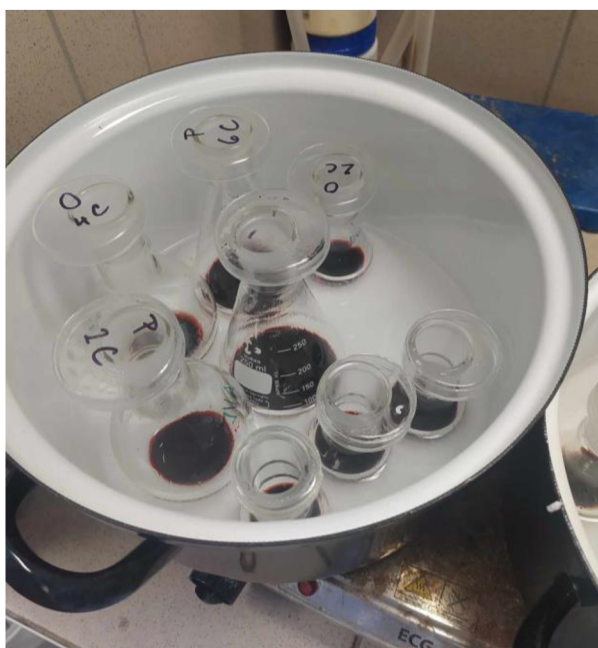
Obrázek 24 Vodní lázeň se vzorky pro stanovení celulózy (Zdroj: autorka práce, 2024)
