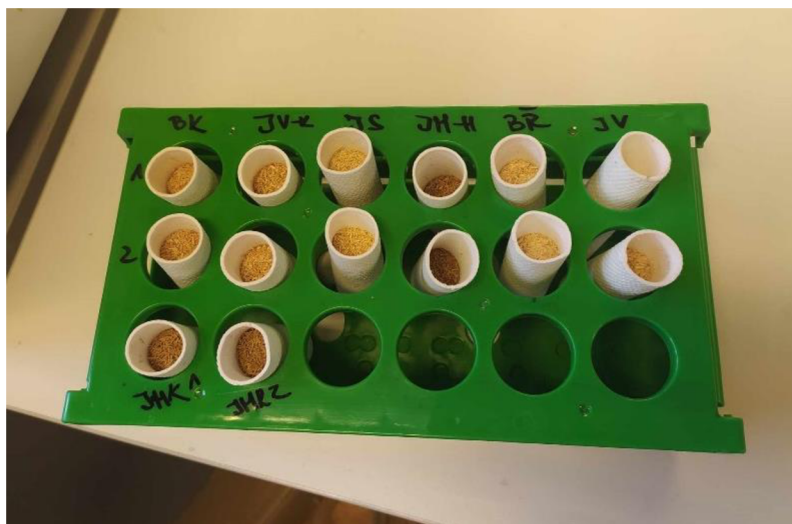
Obrázek 18 Patrony s naváženými vzorky požadované frakce dřevních pilin (Zdroj: autorka práce, 2023)
