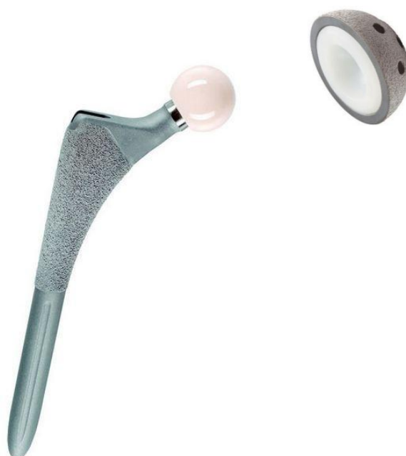
Obr. 3.1: Kyčelní náhrada ze slitiny Ti6Al4V, kotvící část jamky a část dřívku je opatřena kombinovaným porézním povrchem s vrstvou hydroxyapatitu [15]
