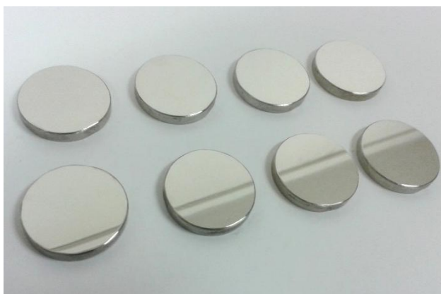
Obr. 6.2: Přístroj Struers Tegramin-25 a vyleštěné vzorky z oceli AISI 316L
