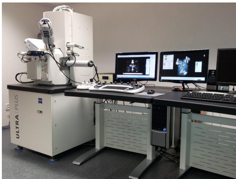
Obr. 6.7: Rastrovací elektronový mikroskop Carl Zeiss ULTRA Plus
