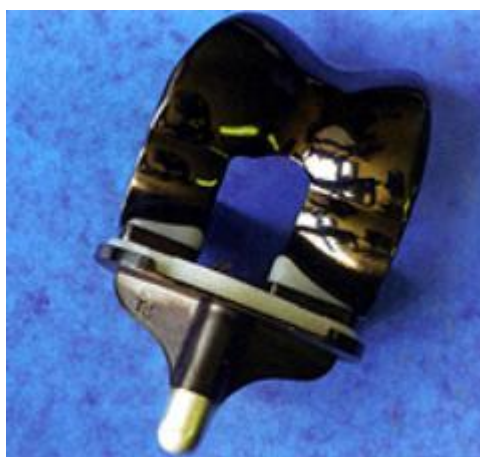
Obr. 3.3: Náhrada kolenního kloubu s DLC povlakem [18]
