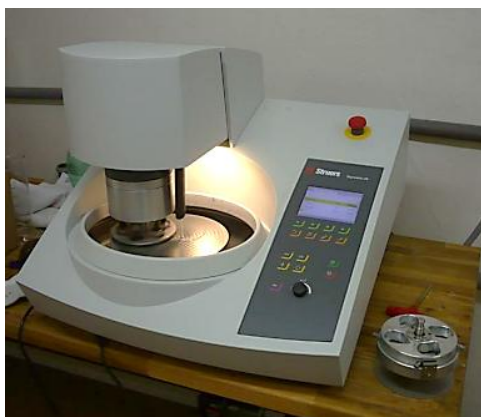
Obr. 6.2: Přístroj Struers Tegramin-25 a vyleštěné vzorky z oceli AISI 316L
