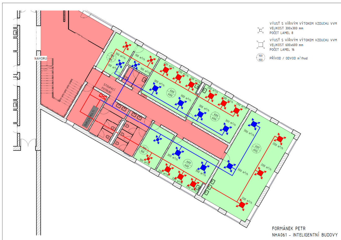
Obrázek 11 - Dispozice přívodu a odvodu vzduchu
