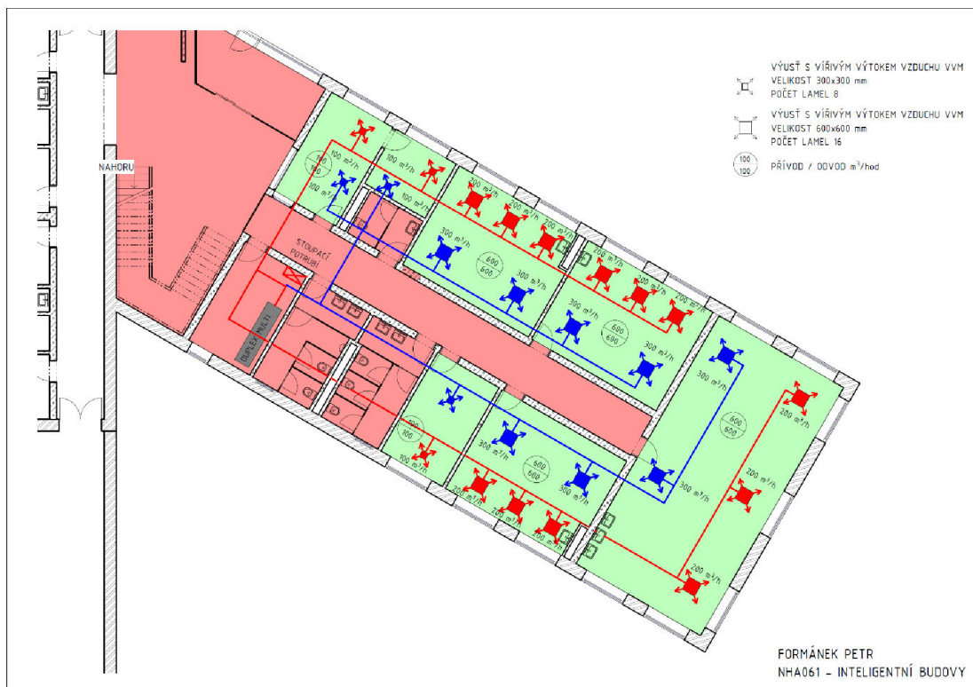
Obrázek 11 - Dispozice přívodu a odvodu vzduchu
