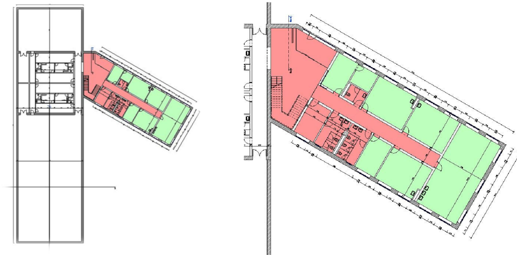
Obrázek 7 - VZT rozdělení objektu
