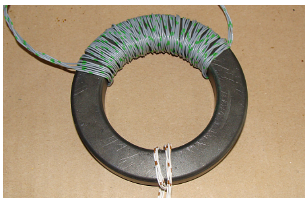
Obr. 4.3: Navinuté primární a sekundární závity na feritovém jádře K4000
