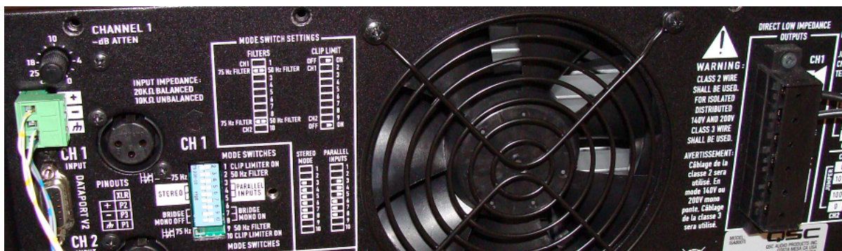
Obr. 4.4: Zapojení vstupních a výstupních konektorů zesilovače ISA 800Ti
