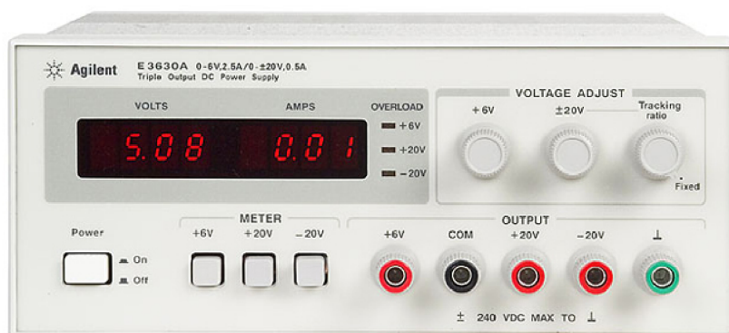
Obr. 3.4: Laboratorní zdroj Agilent E3630A pro napájení proudového čidla LEM LA25-NP
