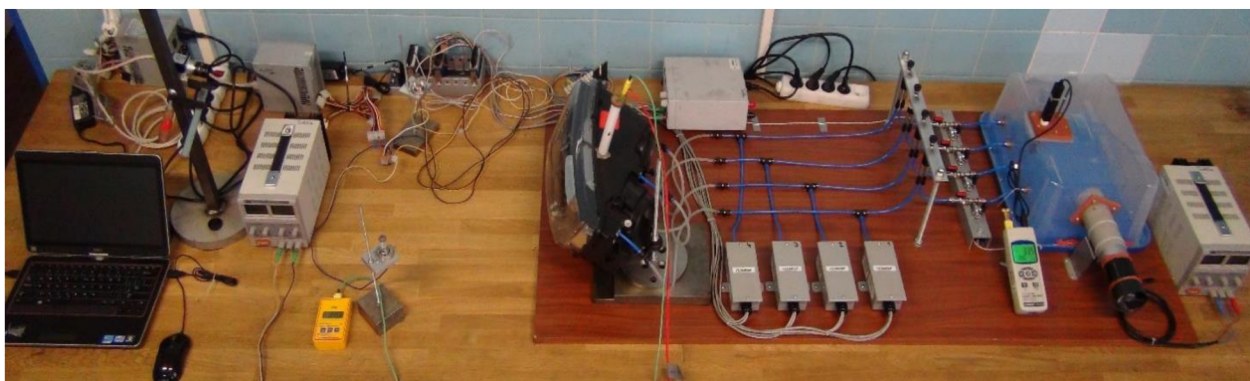
Obr. 2.8 Měřicí zařízení pro odmlžovací testy v2.0
