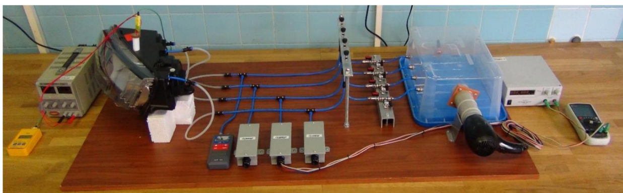
Obr. 2.7 Měřicí zařízení pro odmlžovací testy v1.0
