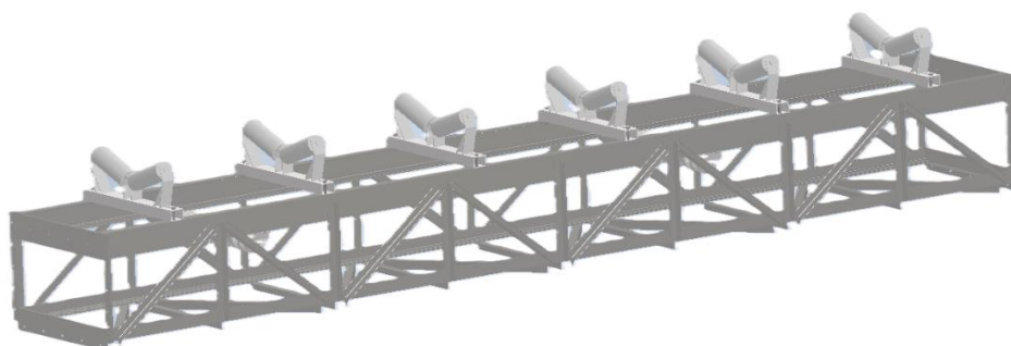
Obr. 32 Návrh rámová konstrukce
