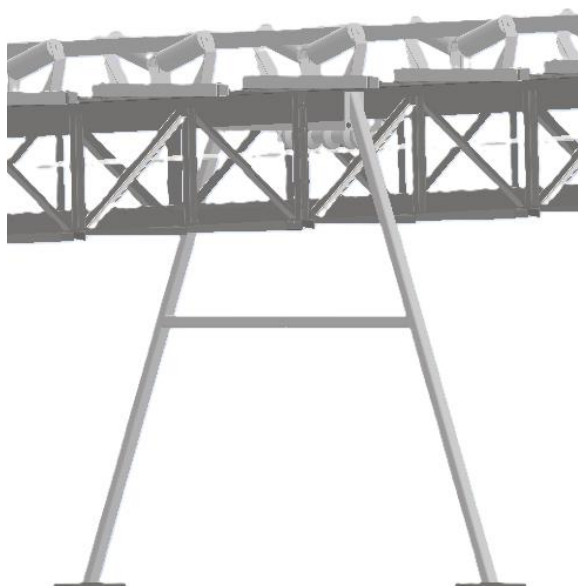
Obr. 33 Návrh konstrukce stojin
