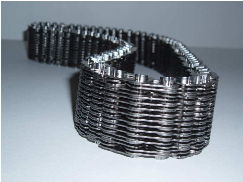
Obr 14 Řetěz převodovky Multitronic [11]
