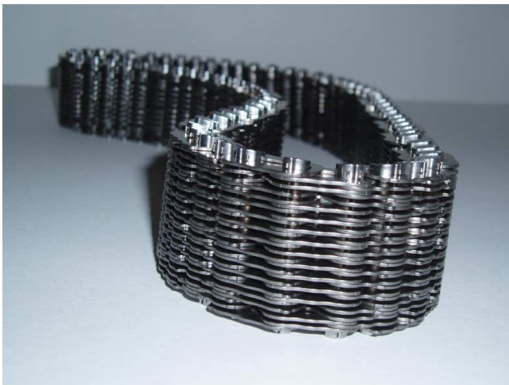
Obr 14 Řetěz převodovky Multitronic [11]
