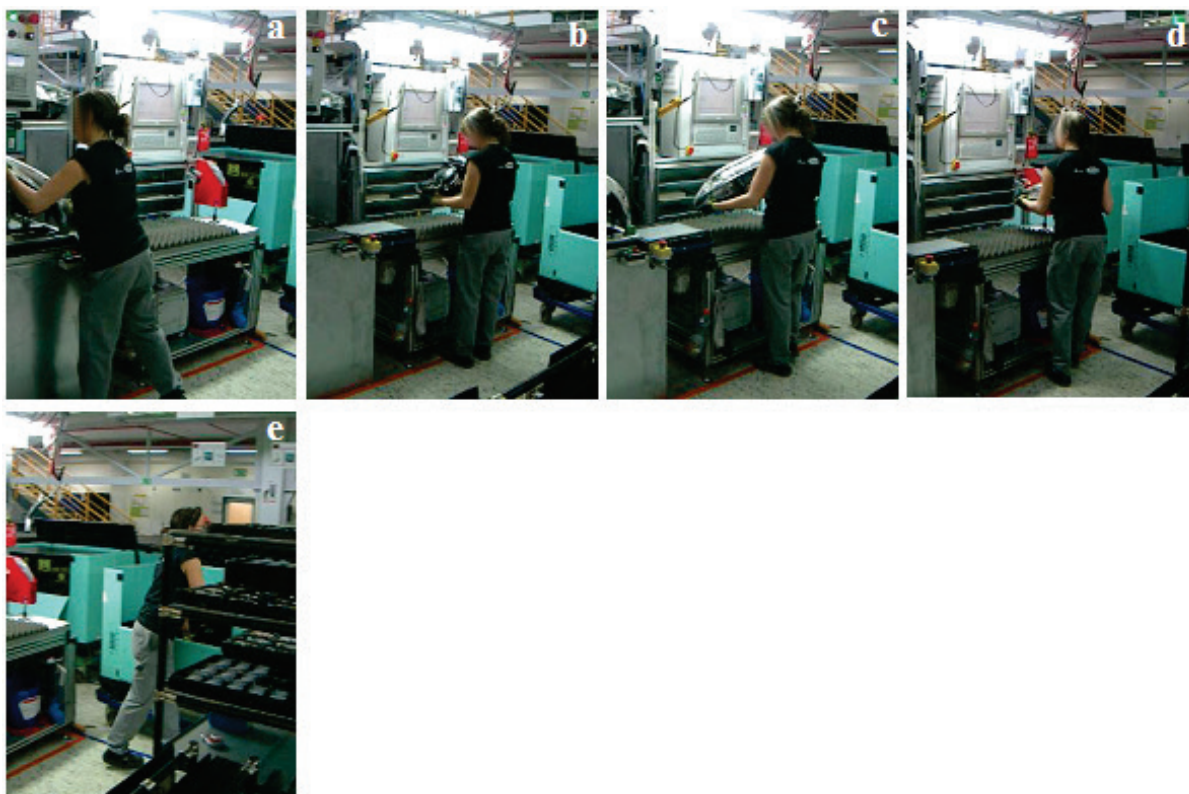
Obr. 30 Pracovní cyklus na pracovišti vizuální kontroly konečné montáže
