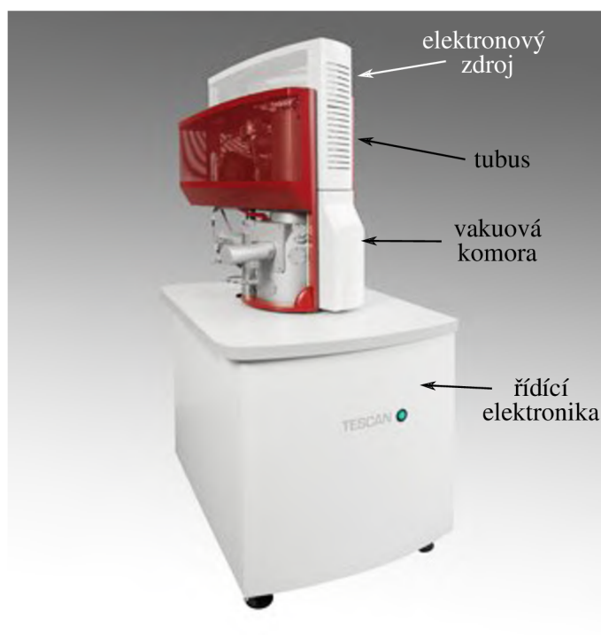
Obrázek 3.3: Elektronový mikroskop MIRA se znázorněnými částmi. Převzato a upraveno z [49].
