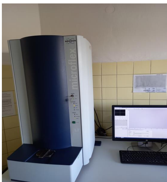
Obr. 13: Hmotnostní spektrometr MALDI-TOF od společnosti Bruker (vlastní foto).
