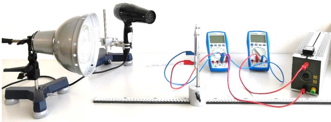
Obr. 7-13: Sestava pro stanovení VA charakteristiky solárního článku v závislosti na teplotě
