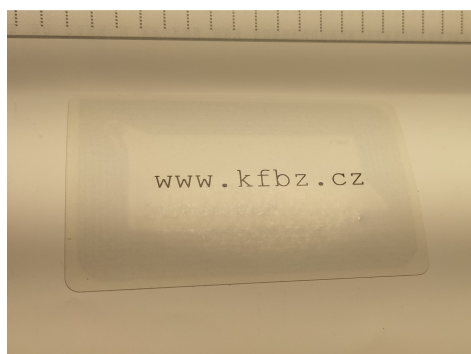
Obrázek 7: Ukázka samolepícího RFID tagu
