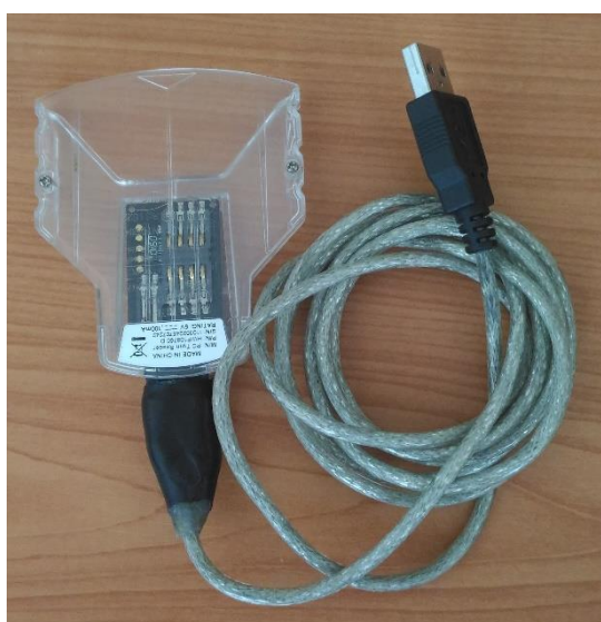
Obr. 26 – Čtečka karet tachografu.
