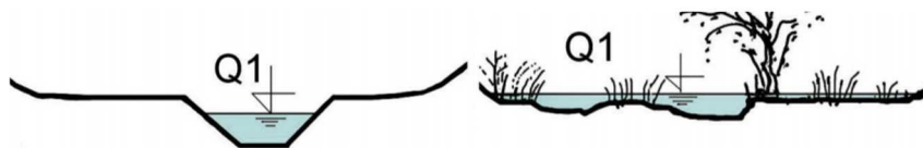
Obr. 7 - Obnova přirozeného povodňování nivy – koryto technicky upravené (vlevo) a přírodní/přírodě blízké (vpravo) [40]
