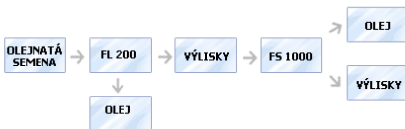
Obrázek č. 6: Schéma procesu – dvoustupňové lisování
