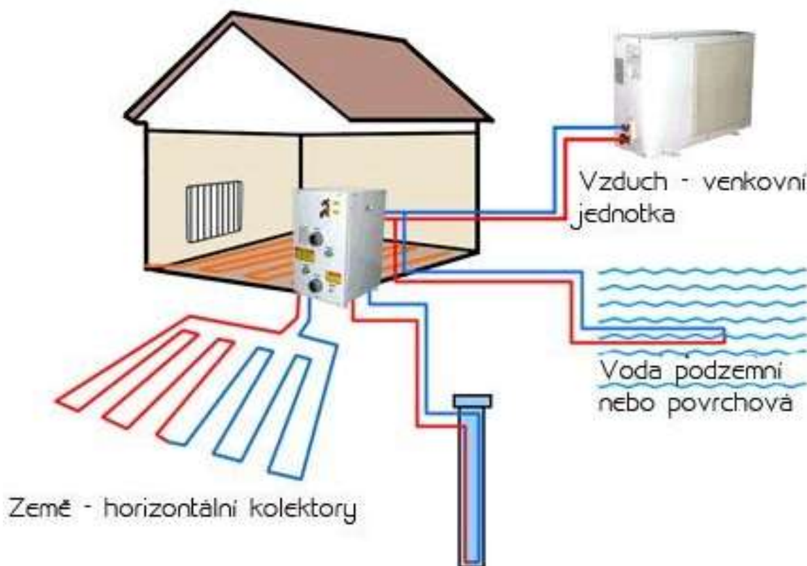
Obr. 2: Možnosti výroby tepla tepelným čerpadlem z nízkopotenciální energie [15]
