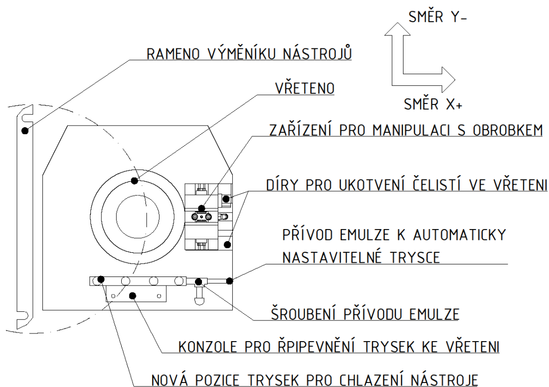
Obr. 8: Pohled na vřeteno zespod. [vlastní zpracování]
