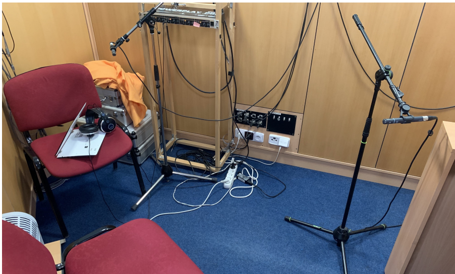
Obr. 4.17: Rozestavení mikrofonů při odděleném snímání
