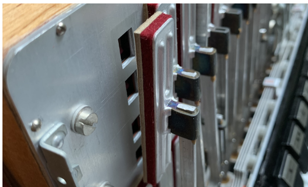
Obr. 1.5: Klávesou nadzvednutá podložka a otvory pod ní
