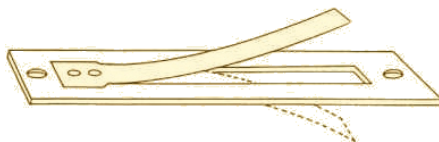
Obr. 1.1: Princip průrazného jazýčku, převzato z [2]
