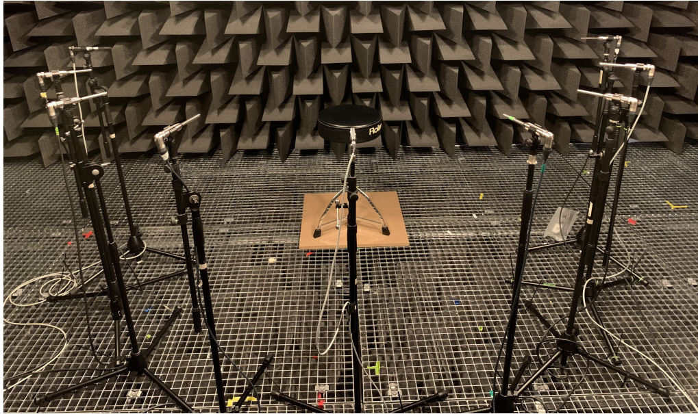
Obr. 2.2: Pohled na rozestavení měřících mikrofonů
