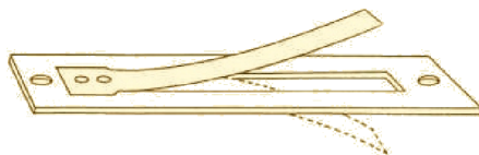
Obr. 1.1: Princip průrazného jazýčku, převzato z [2]
