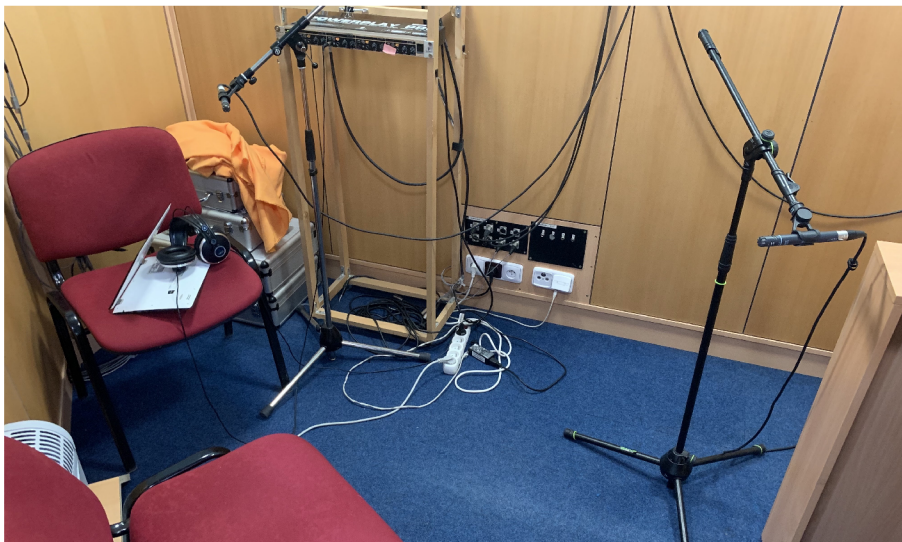
Obr. 4.17: Rozestavení mikrofonů při odděleném snímání
