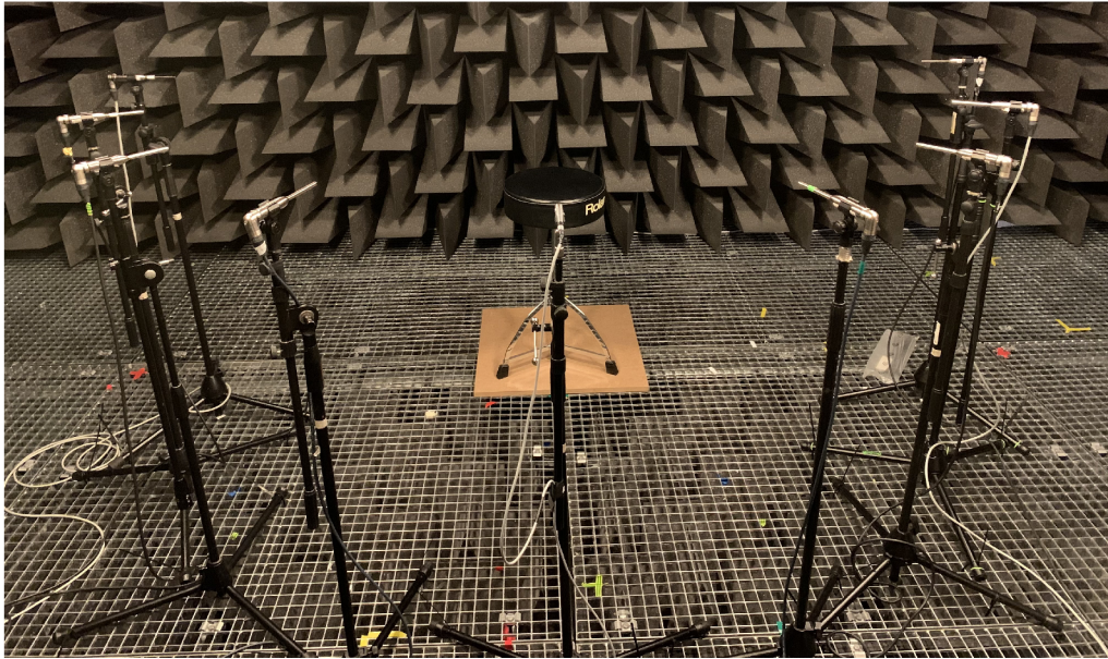
Obr. 2.2: Pohled na rozestavení měřících mikrofonů
