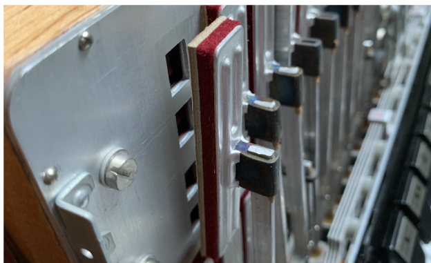
Obr. 1.5: Klávesou nadzvednutá podložka a otvory pod ní
