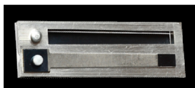
Obr. 1.2: Dva průrazné jazýčky v rámečku, z každé strany jeden, převzato z [2]
