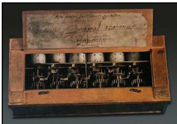
Obrázek 7: Mechanická kalkulačka "Pascaline"
