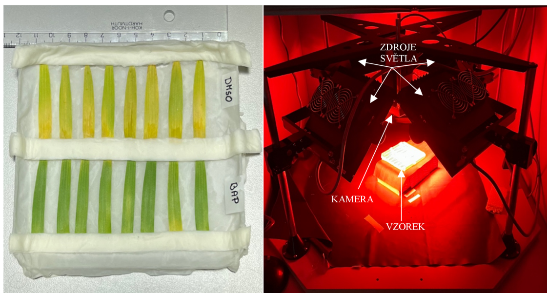
Obr. 5: Oddělené listy ječmene variant DMSO a BAP přemístěny z roztoků v mikrotitrační destičce na desku s navlhčeným filtračním papírem (vlevo); komora FluorCamu 800 při ozáření vzorků červeným světlem (vpravo).
