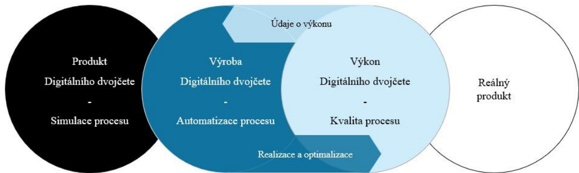
Obrázek 1 - Zjednodušené zobrazení principu fungování digitálního dvojčete
