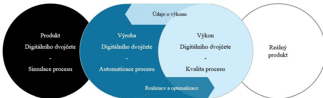
Obrázek 1 - Zjednodušené zobrazení principu fungování digitálního dvojčete
