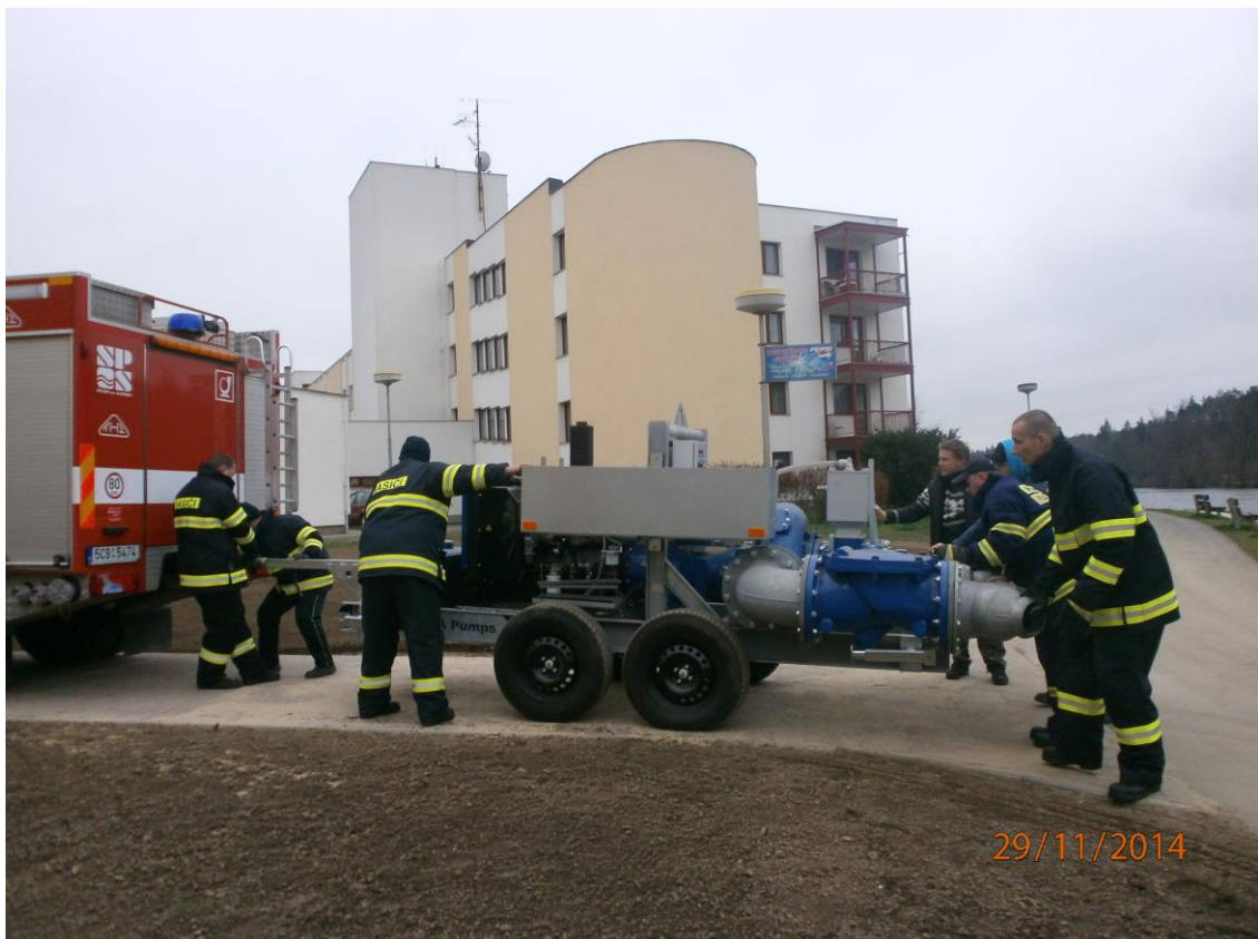
Obrázek 6: Mobilní čerpací stanice BBA Pumps 300
