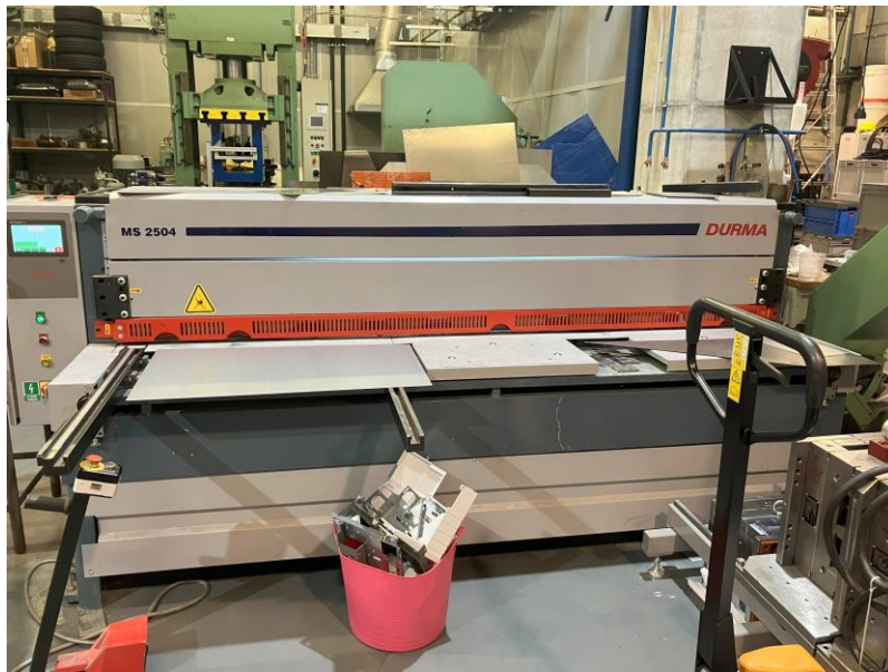
Obr. 3.4 CNC tabulové nůžky DURMA MS 2504 [vlastní zdroj]
