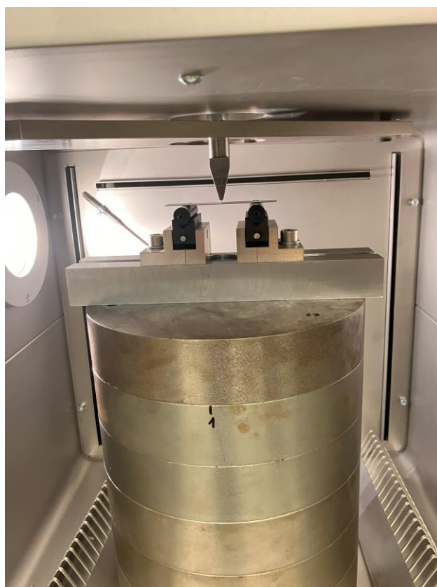
Obr. 3.13 Přípravek s uloženým vzorkem namontovaný do padostroje [vlastní zdroj]
