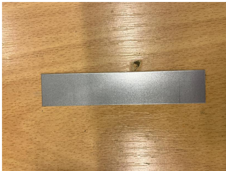
Obr. 3.5 Výstřížek z plechu CR 180 BH ZM 40/40 E-O [vlastní zdroj]
