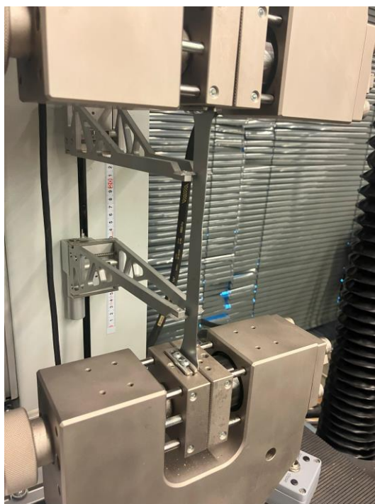
Obr. 3.1 Vzorek upnutý do zkušebního zařízení s přiloženým průtahoměrem [vlastní zdroj]
