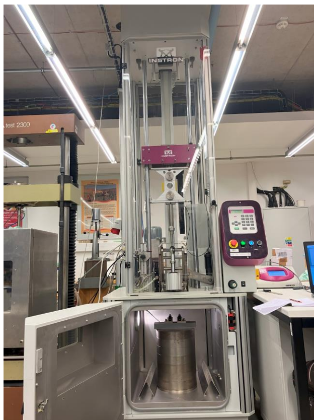
Obr. 3.12 Padostroj INSTRON CEAST 9350 s teplotní komorou [vlastní zdroj]
