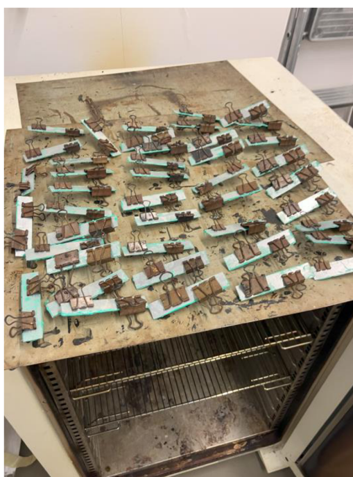
Obr. 3.8 Vytvrzené vzorky na sušárně BMT VENTICELL s fixačními sponami [vlastní zdroj]
