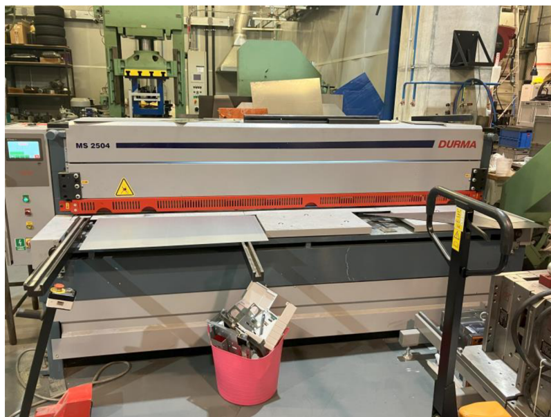
Obr. 3.4 CNC tabulové nůžky DURMA MS 2504 [vlastní zdroj]
