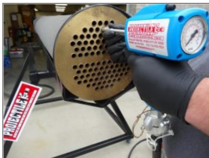
Obr. 7 Metoda tlakové pistole (převzato z [29])
