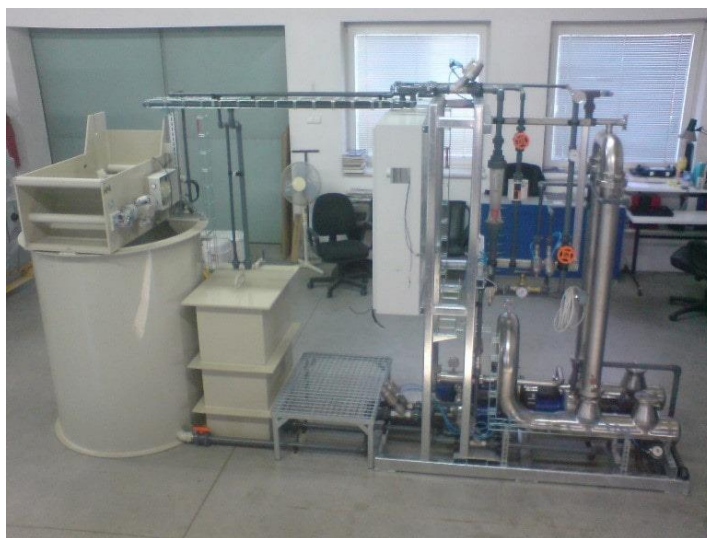
Obr. 24 Ilustrativní obrázek membránového ultrafiltračního zařízení od společnosti GREEN – TECH M+H, s.r.o. [41]
