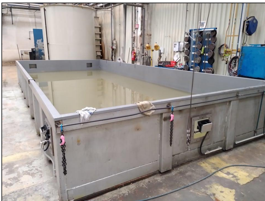
Obr. 20 Testovací vana pro testování větších tepelných výměníků o objemu 17 m 3
