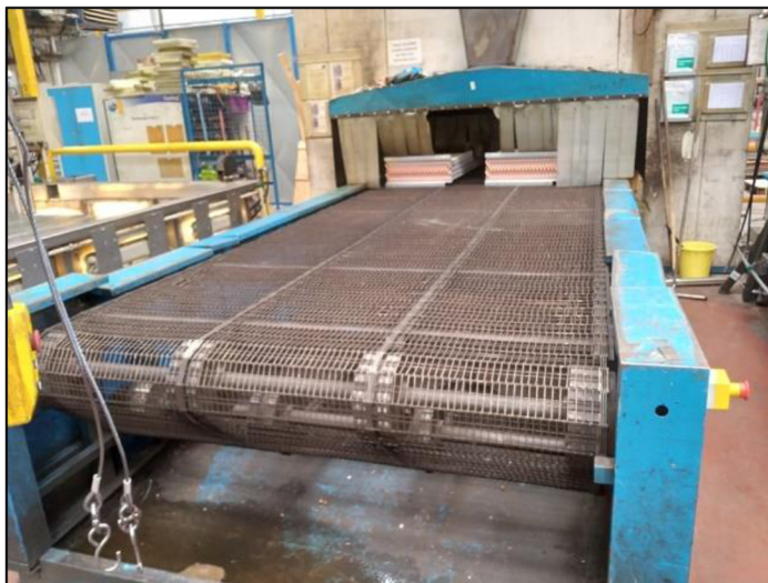
Obr. 21 Sušící pec s pásovým dopravníkem
