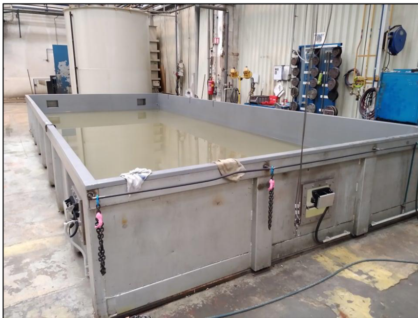
Obr. 20 Testovací vana pro testování větších tepelných výměníků o objemu 17 m 3
