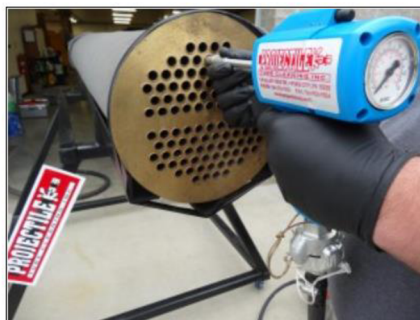
Obr. 7 Metoda tlakové pistole (převzato z [29])
