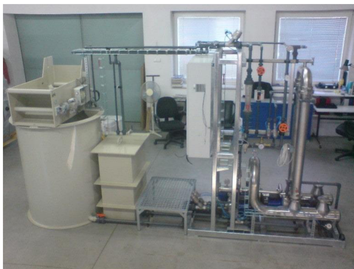
Obr. 24 Ilustrativní obrázek membránového ultrafiltračního zařízení od společnosti GREEN – TECH M+H, s.r.o. [41]
