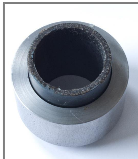
Obr. 71 Plášť z 11SMn30 s drážkami zalitými plastem PR 700
