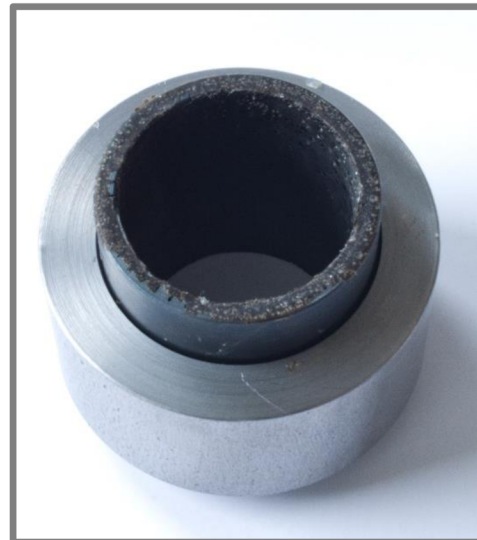
Obr. 71 Plášť z 11SMn30 s drážkami zalitými plastem PR 700
