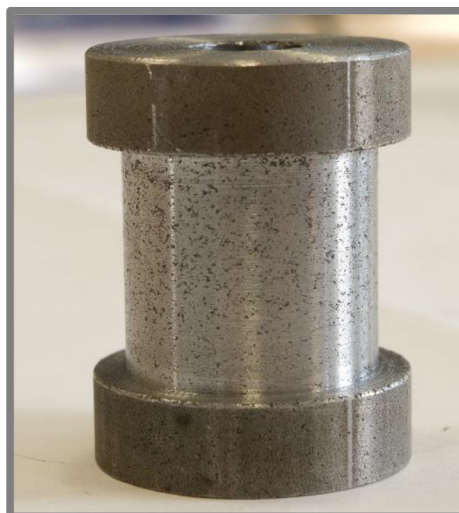
Obr. 53 Vzorek SMC prototyping po obrobení
