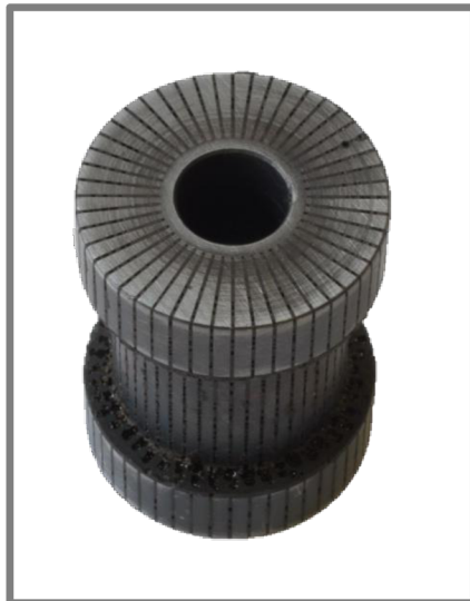
Obr. 70 Jádru z 11SMn30 s drážkami zalitými plastem PR 700
