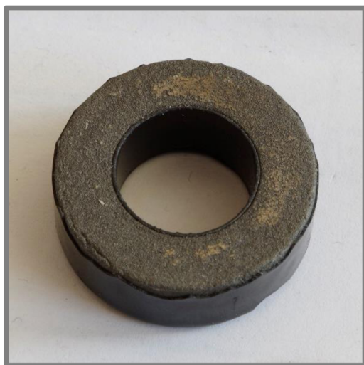
Obr. 52 Vzorek Kool M \mu po obrobení
