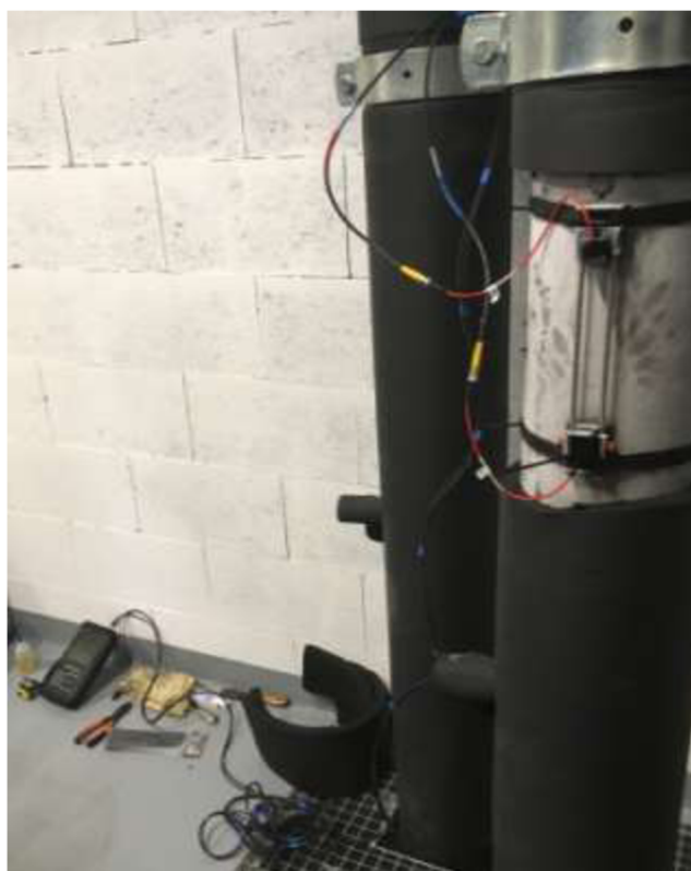
Obr. 35: Měření objemového průtoku okruhu ledové plochy
