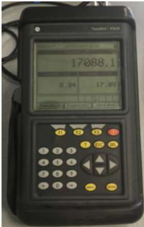
Obr. 33: Ultrazvukový průtokoměr TransPort PT878 a nfračervený teploměr Testo 830-T4 [42]
