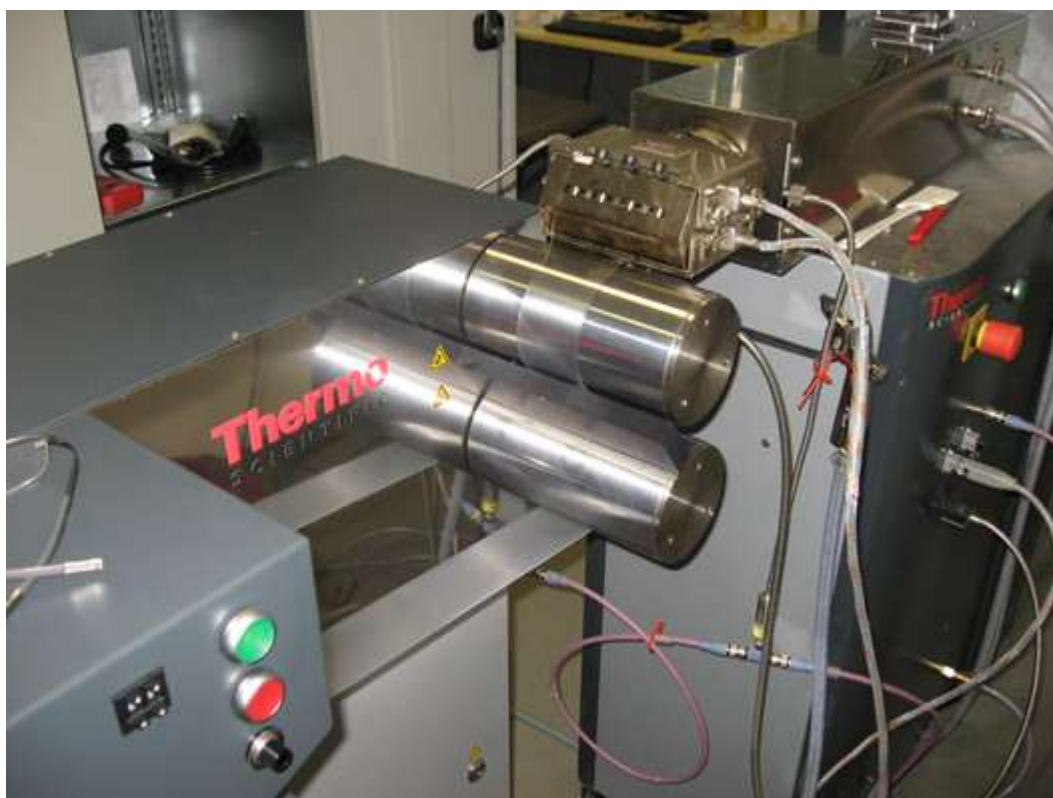
Obr. 16: Používaná chill-roll technológia na prípravu fólií.
